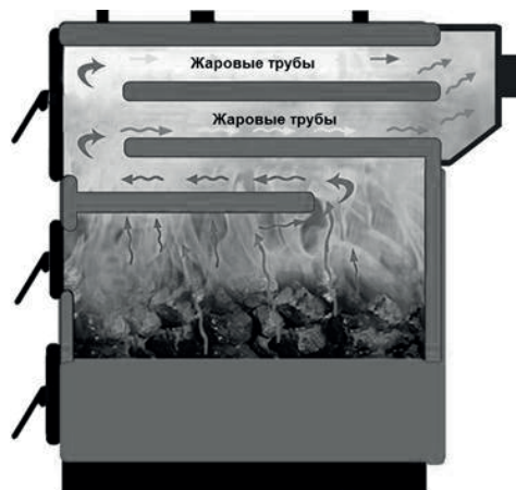
Рис. 3. Котел VULKAN SR 20-100, схема движения дымовых газов.
